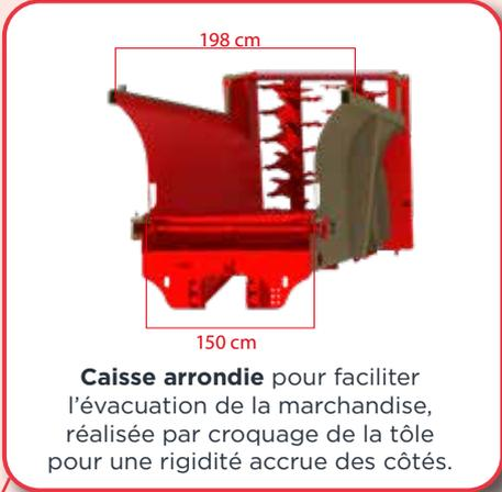
Caisse arrondie pour faciliter l'évacuation de la marchandise, réalisée par croquage de la tôle pour une rigidité accrue des côtés.
